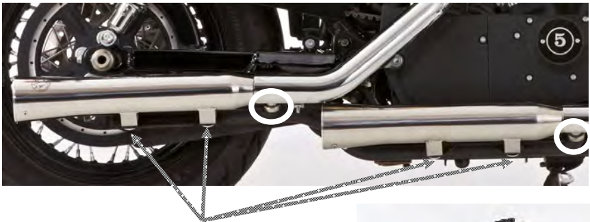
Verschraubungen des Endschalldämpfers am Original-Halter
