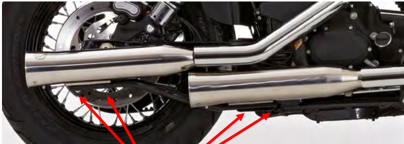
Verschraubungen des Endschalldämpfers am Original-Halter
